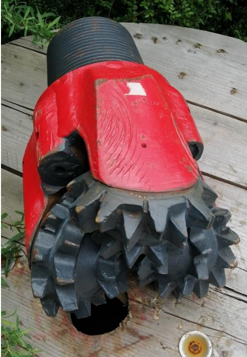
Tête de forage du doublet géothermique
