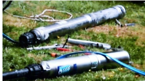
Les deux pompes immergées par -30m Hauteur refoulement 90m, 2900 RPM P moteur électrique = 0,75kW unitaire
