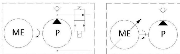
*Les deux technologies : à gauche l'entraînement à vitesse constante pour les petites puissances avec le dispositif de mise à vide électronique (Voir **les composants des pompes à chaleur**) et à droite pour les puissances importantes l'entraînement par moteur électrique à vitesse variable bien connu des électriciens entraînant une pompe à vis ou à pistons.*
