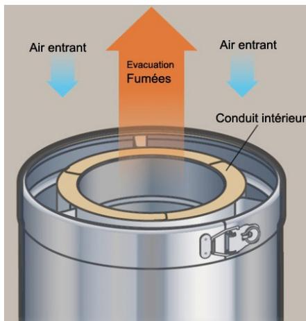
*Une solution pour y parvenir est par exemple de faire fonctionner le conduit d'évacuation des gaz brûlés comme un échangeur à contre-courant. L'air froid de combustion circulant dans l'anneau extérieur refroidit les gaz brûlés à haute température circulant dans le tube central avant leur rejet dans l'atmosphère. L'air de combustion arrive plus chaud dans la chambre de combustion améliorant le rendement. (Courtesy Poujoulat)*
