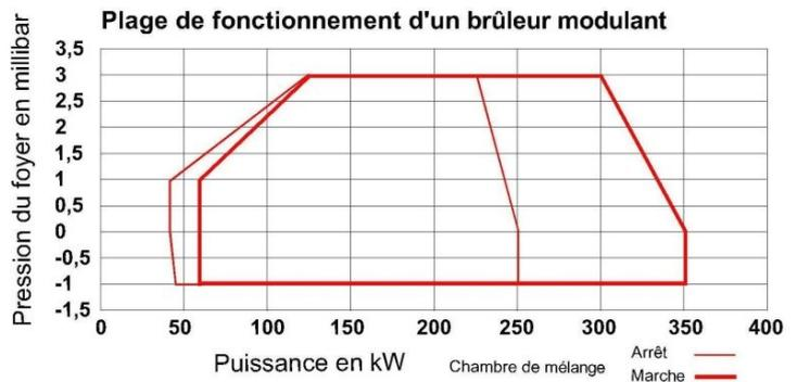
Courbes de fonctionnement d'un brûleur modulant. La gestion numérique de la combustion gaz ou fioul permet au brûleur modulant de couvrir une plage de puissance pouvant aller jusqu'à 12% de sa puissance nominale. L'amélioration du rendement par rapport à un fonctionnement en tout ou rien peut aller jusqu'à 40% Courtesy Weishaupt
