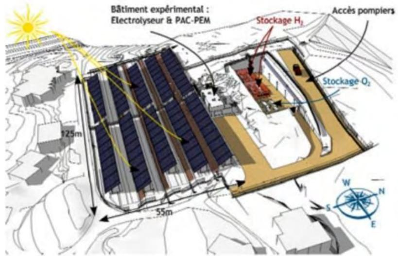
*Inauguré début 2012 la plateforme de recherche Myrte associe 3700 m<sup>2</sup> de panneaux solaires photovoltaïques (560 kWc) et une station de production de l'hydrogène par électrolyse pour les besoins d'une grosse pile à combustible. Courtesy Areva.*
