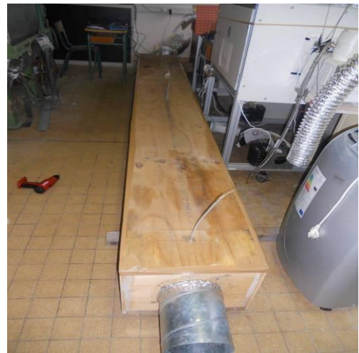
Figure 103 : Caisson-MCP du dispositif expérimental avec les différents thermocouples
