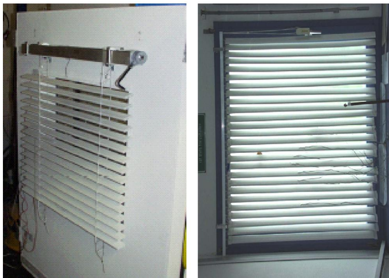
Figure 11 : Rideaux à MCP mis au point par Harald Melhing et al (d'après Atul et al., 2007)
