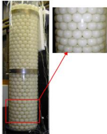
Figure 25 : Système de rafraîchissement mis au point par d'Arkar et al. (d'après Arkar et al, 2005, 2007).
