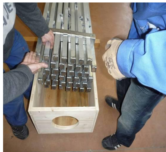
Figure 91 : Installation de l'échangeur dans le caisson
