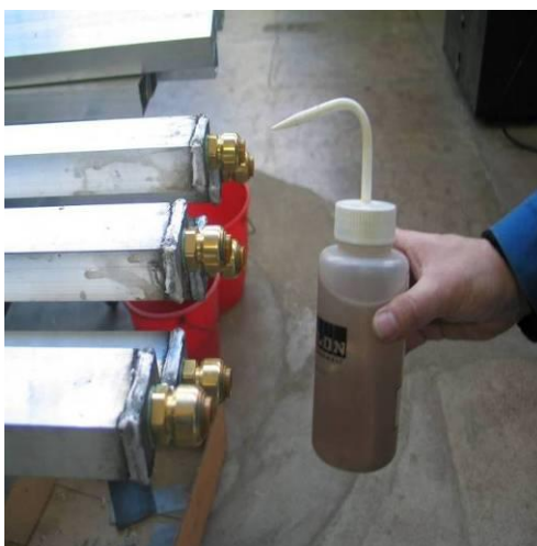
Figure 72 : Remplissage d'eau dans les tubes
