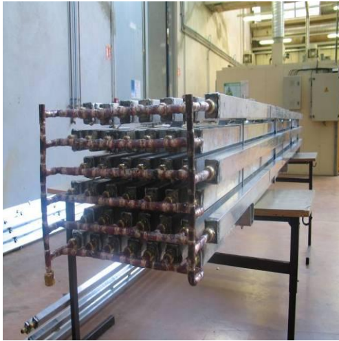
Figure 86 : vue de face d'un échangeur
