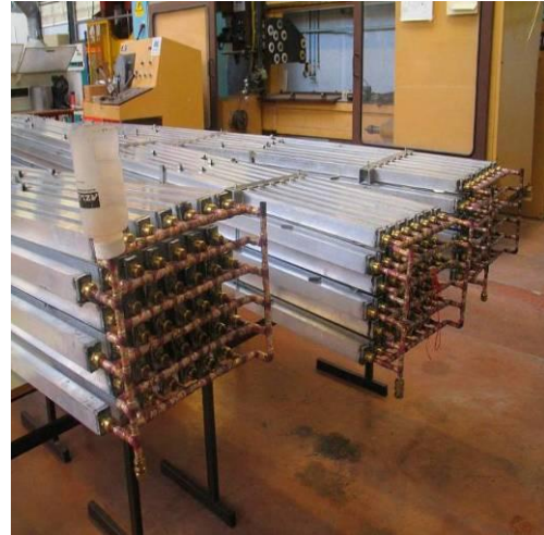
Figure 89 : phase de 2 h d'attente pour tester l'étanchéité
