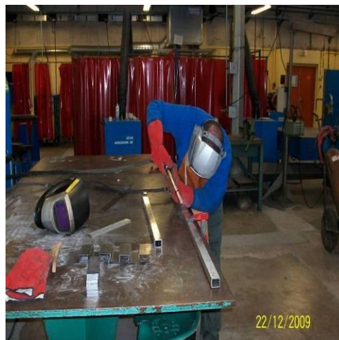
Figure 63 : Assemblage des chutes de tubes par soudure
