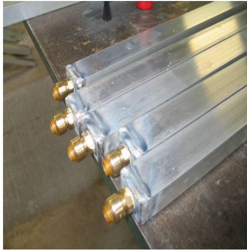
Figure 81 : Solution de remplissage de MCP retenue (raccords tectites en extrémité)
