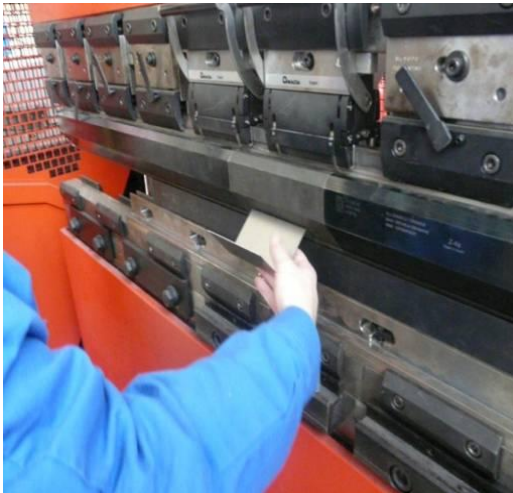
Figure 74 : Fabrication des déflecteurs
