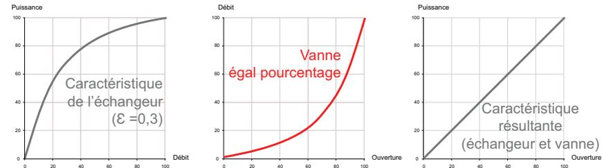
Courbes caractéristiques pour un échangeur, une vanne égale pourcentage et la combinaison des deux (Guide RAGE)
