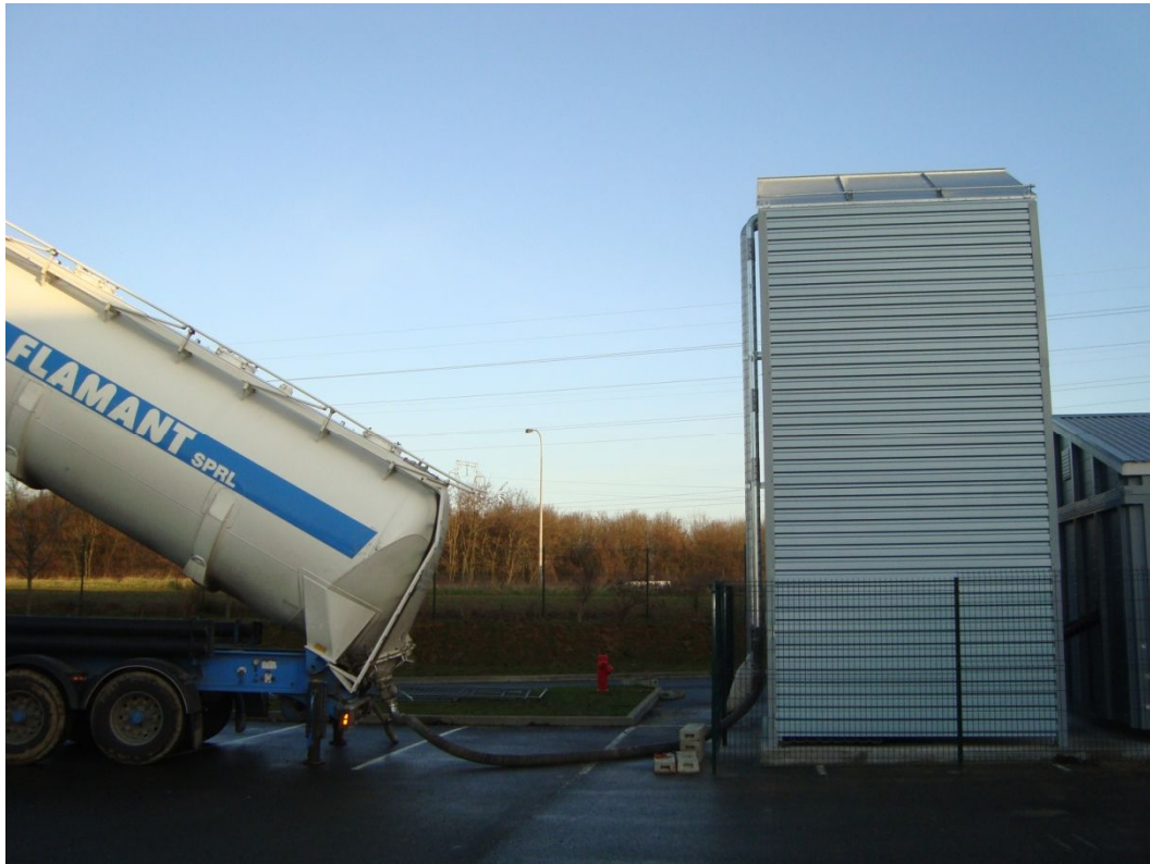
Exemple de silo métallique 55m3 en remplissage par un camion 25 tonnes
